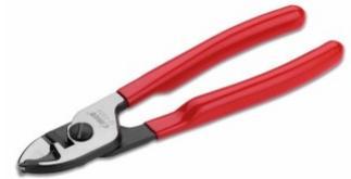
Kabelschere, Universelle Kabelschere für Kupfer-, Aluminium- und Koaxialkabel. Das Werkzeug eignet sich zum exakten Schneiden von Kabeln, Zusatzschneide zum Schneiden von Stahldrähten, Griffe mit einfacher Tauchbeschichtung. 12 mm Durchmesser
