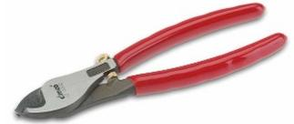
Abisolier-Kabelschere Universelle Kabelschere für Kupfer- und Aluminiumkabel. Für mehradrige, massive Leiter bis 16 mm<sup>3</sup>. Abisolierfunktion mit Stellschraube zum Einstellen auf den gewünschten Draht- oder Litzendurchmesser von 0,5 bis 2,0 mm (spezielle Zone am Schneidkopf). Das Werkzeug eignet sich zum Entmanteln 4 16 mm (im Schneidbereich) und zum exakten Schneiden von Kabeln. Mit einfacher Tauchbeschichtung.
