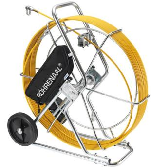
Röhrenaal - Das Kabeleinziehsystem für die Erdverkabelung, verzinktes Stahlrohrgestell, auf Rollen fahrbar, kugelgelagerte Haspel mit integrierter Feststellbremse, komplett mit Glasfaserstab, zwei Anfangshülsen M12, Anfangsbirne 25mm Durchmesser, Schäkel, Verbindungs- und Spannhülsen, 1 Spezialkleber, Bandstärke 9mm Durchmesser, Länge 60m
