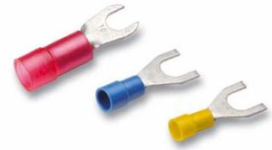
Quetschkabelschuhe, Gabelform Cu, isoliert, DIN 46237 von 0,5 - 6 mm<sup>3</sup> Technische Daten - Werkstoff: Cu-ETP DIN EN 13600 - Oberfläche: galvanisch verzinkt - Für zugentlastete Verbindungen - Isolation PA (Polyamid, Nylon), halogenfrei - Temperaturbeständigkeit 60 Grad C bis +105 Grad C - Easy Entry ermöglicht einfaches und schnelles Einführen des Leiters 1,5-2,5 mm<sup>3</sup>, für Anschlussbolzen 3mm, blau
