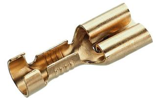
Flachsteckhülsen mit Rastzunge, nicht isoliert. Technische Daten: Werkstoff: Messing, blank, DIN 46340, Teil 1-3 und ähnliche Ausführungen. 1,5-2,5qmm. 6,3 x 0,8mm Steckermaß.
