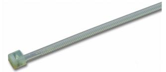
Hitzebeständige Kabelbinder durch besondere Additive im Rohmaterial dauerhaft temperaturbeständige Kabelbinder bis +130 Grad C, Eigenschaften ansonsten wie Standard-Kabelbinder, Grundmaterial reines Polyamid 6. 6 ohne Recyclinganteile, Farbe blassgrün, BxL 4, 5x280mm, KabelBaum, 5-76mm, Mindestzugfestigkeit 22kp/216N
