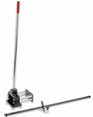
DIN Profil Schneid- und Stanzgerät Zum gratfreien Ablängen ohne Abfall - Für Tragschienen - Verringerter Kraftaufwand mit verstärktem Exzenter - Lasergravierter Längenanschlag bis 1000 mm - Handbetätigung zum Ablängen und Lochen in Längs- und Quer-Ausführung Profilbestückung: TS 35x15 - TS 35x7, 5 - TS 15x5, 5 - E-Cu 10x3, 0 - C 15x34
