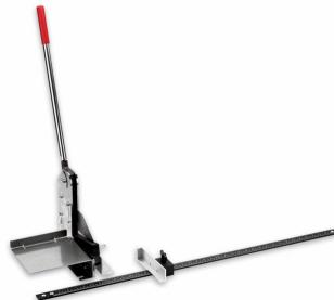
Verdrahtungskanal-Schneider Zum gratfreien Ablängen ohne Abfall- Für Kunststoffkanäle und Deckel Geringer Kraftaufwand beim Schneiden - Klappbarer und gefederter Messerschutz - Befestigungslaschen für die Werkbankmontage - Schneidenbreite bis 125 mm - Lasergravierter Längenanschlag bis 1000 mm
