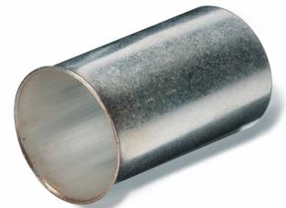
Nicht isolierte Aderendhülsen DIN 46228, Teil 1 und Sonderabmessungen Technische Daten - Werkstoff: Cu-ETP DIN EN 13600 - Oberfläche: galvanisch verzinkt 1, 5 mm<sup>2</sup> x 18 mm
