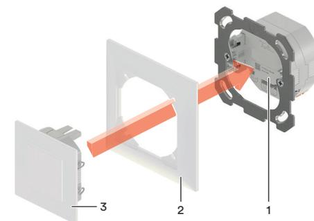
Nell'EDIZIOdue il set di copertura e il modulo di comando sono già premontati (comando).
