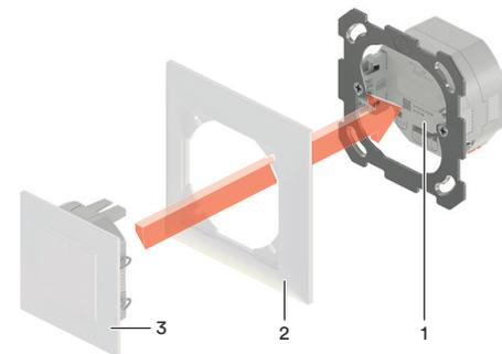
Avec EDIZIOdue, le set de recouvrement et le module de commande sont déjà prémontés (commande).
