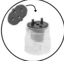
Stellen Sie den Fixadapter auf eine ebene Fläche und legen Sie die Dichtung auf.
