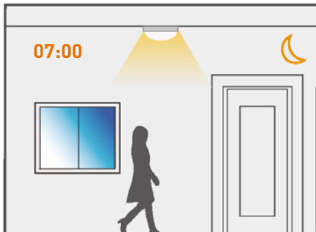
Das Licht schaltet automatisch ein, wenn das natürliche Licht unter der Tageslichtschwelle liegt und eine Person detektiert wird.
