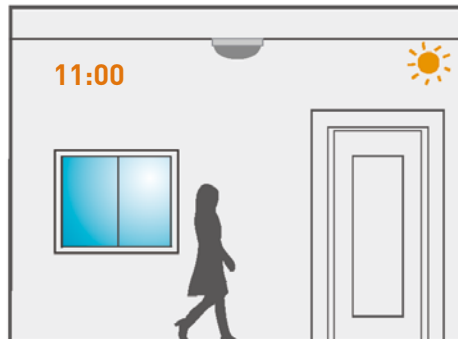
Das Licht schaltet automatisch aus, wenn das natürliche Licht die Tageslichtschwelle während 5 Minuten überschreitet, auch bei Anwesenheit einer Person.
