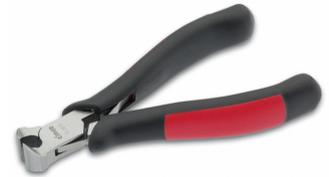
Elektronik-Vornschneider, mit breiter Schneide und Wate, mit Schneide Präzisions-Elektronikzangen mit durchgestecktem Gelenk, gesenkgeschmiedete Ausführung hochpräzise Ausführung aus Spezialstahl, leicht selbstöffnend durch Doppelblattfedern, hohe Standzeit, Flächen fein geschliffen, mit ergonomischen Zwei-Komponenten Griffhüllen (in ESD oder 1000 V Ausführung auf Anfrage)
