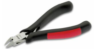
Elektronik-Seitenschneider ovalrunder Kopf, schräg, ohne Schneidwate Präzisions-Elektronikzangen mit durchgestecktem Gelenk, gesenkgeschmiedete Ausführung hochpräzise Ausführung aus Spezialstahl, leicht selbstöffnend durch Doppelblattfedern, hohe Standzeit, Flächen fein geschliffen, mit ergonomischen Zwei-Komponenten Griffhüllen (in ESD oder 1000 V Ausführung auf Anfrage)
